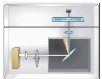
Epoch2采用单色器进行波长选择，这意味着用户可以通过简单的触碰，就可以完成799种波长的选择，再也无需为更换滤光片而苦恼。无论是动力学还是终点法检测，都可以实现1nm步进的选择，并且可完成任意单波长、双波长或多波长的分析操作。系统采用独特的无光纤双光束设计，光路简洁高效并内置参比通道，确保每次检测的精准无误。
